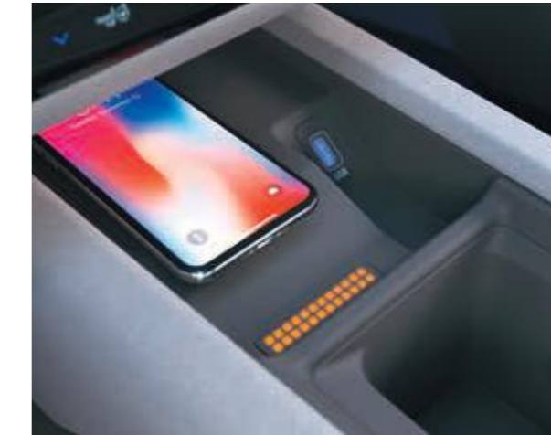
Yüksek hızlı kablosuz şarj yuvası, akıllı telefonunuzun şarj seviyesini bir bakışta gösteren Parametrik Piksellere sahip.
